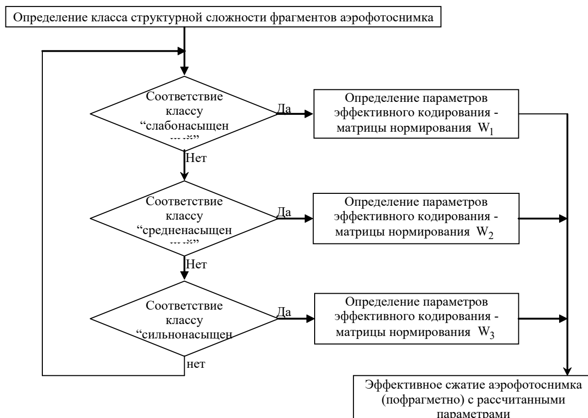
Рис. 2. Структурно-функциональная схема алгоритма определения параметров нормирования
