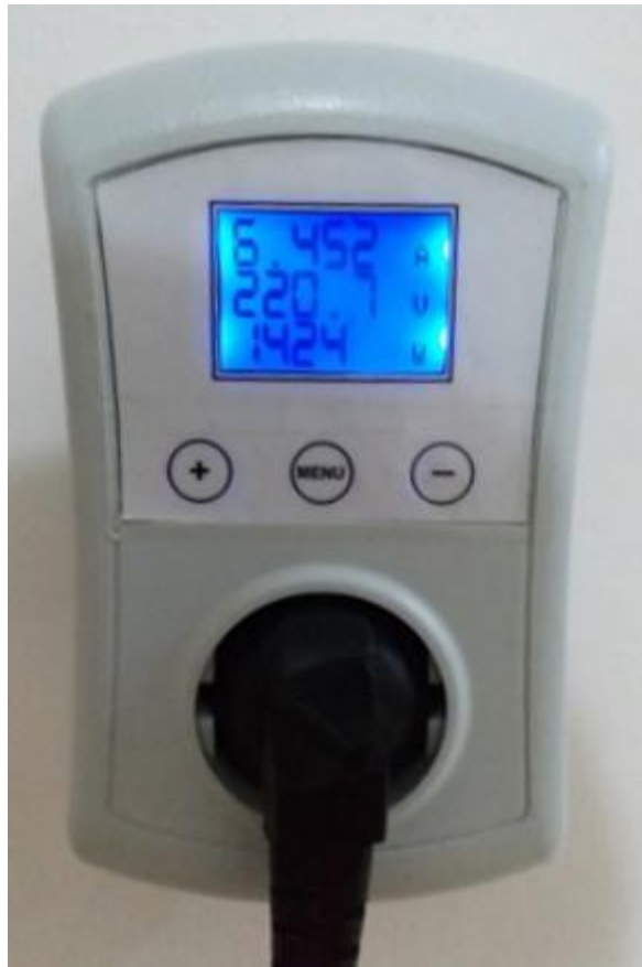
Рисунок 4.5. Модуль вимірювання потужності та керування
