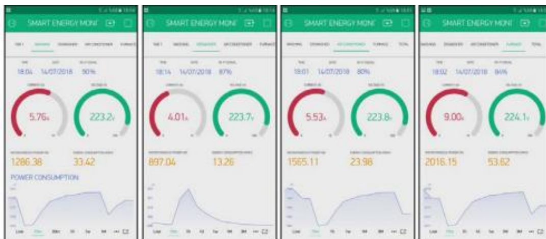
Рисунок 4.8 Панелі користувача для моніторингу пральної машини, посудомийної машини, кондиціонера та духової печі.
