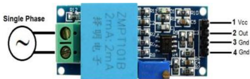
Рисунок 4.3 ZMPT101B датчик напруги
