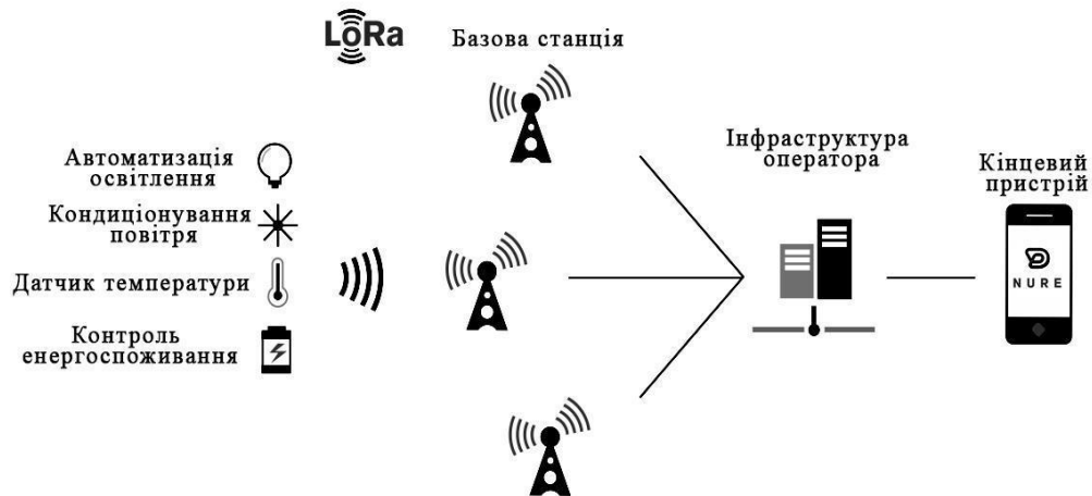
Рисунок 1 – Принципова схема побудови мережі LoRaWAN
