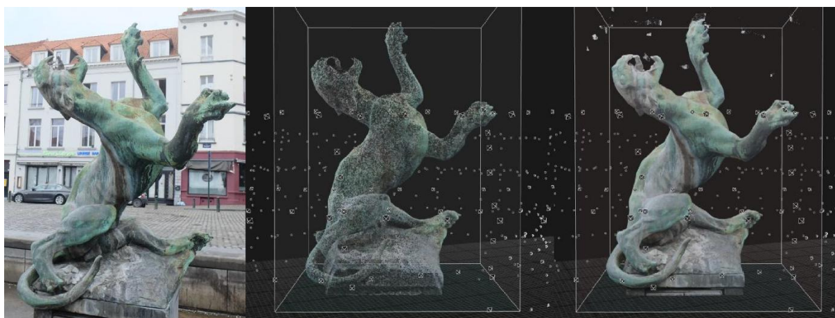
Рисунок 1 – Етапи створення 3D-моделі методом фотограмметрії
