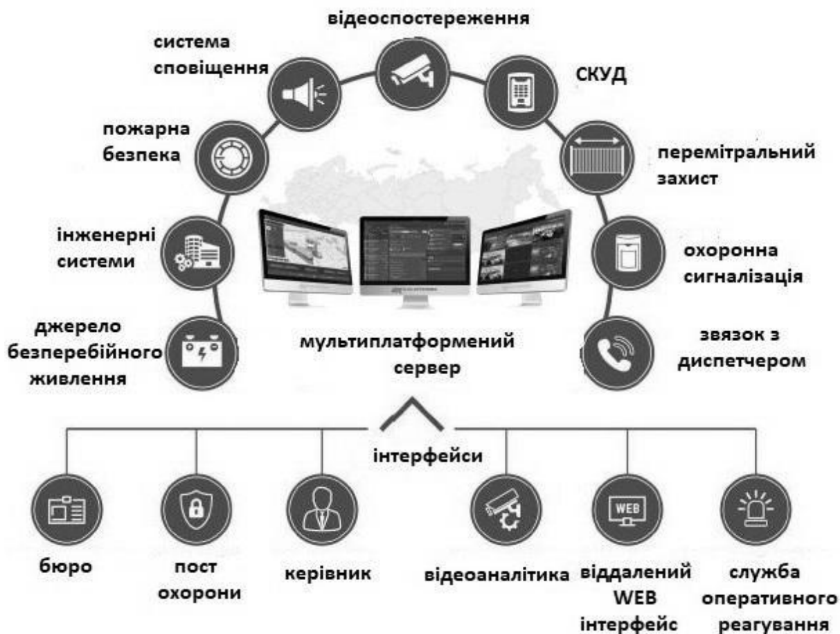
Рисунок 1 – Структурна схема роботи платформи PSIM
