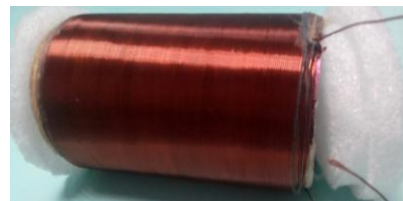
Рисунок 1 – Креслення і фото виготовленого багат шарового соленоїда
