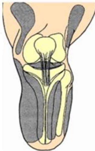
Рисунок 2.18 – Ділянки, толерантні до тиску в куксі гомілки під час навантаження в протезі
