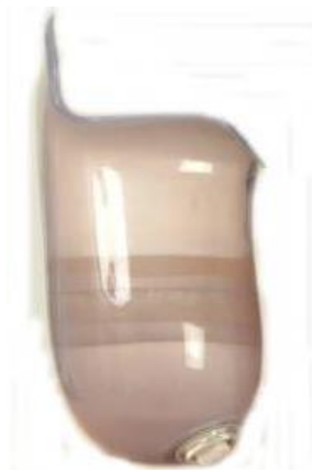
Рисунок 3.25 – Діагностична гільза кукси стегна
