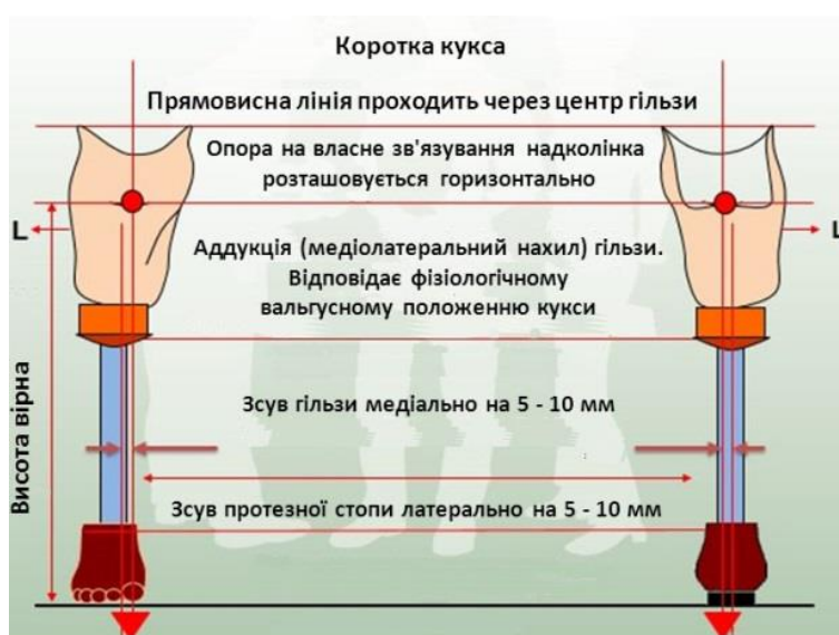
Рисунок 4.4 – Рекомендації щодо побудови протеза гомілки залежно від довжини кукси
