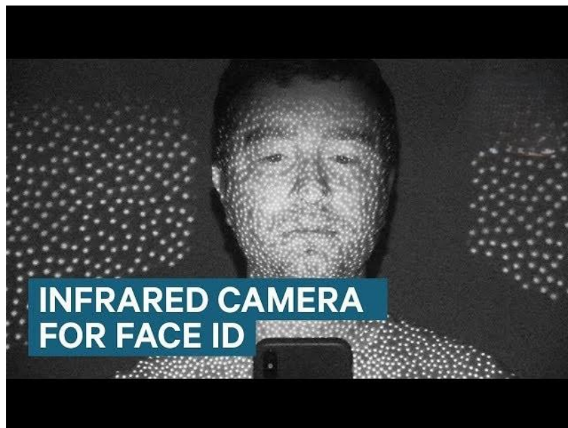
Рисунок 2.4 – Інфрачервоні датчики у технології Apple Face ID
