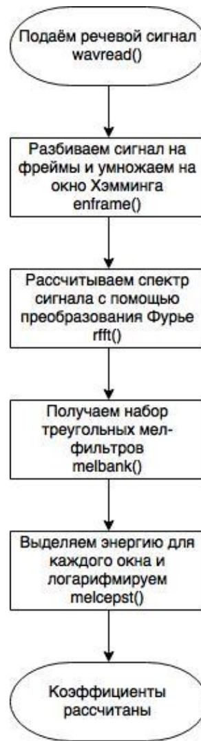
Рисунок 4.5 – Схема алгоритму обчислень мел-кепстральных коефіцієнтів
