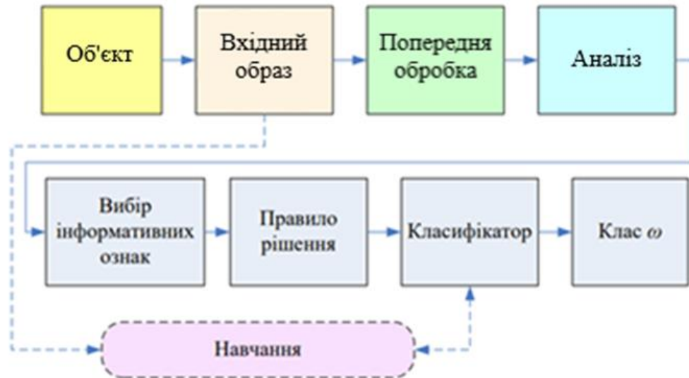
Рисунок 1.1 – Функціональна схема системи розпізнавання образів
