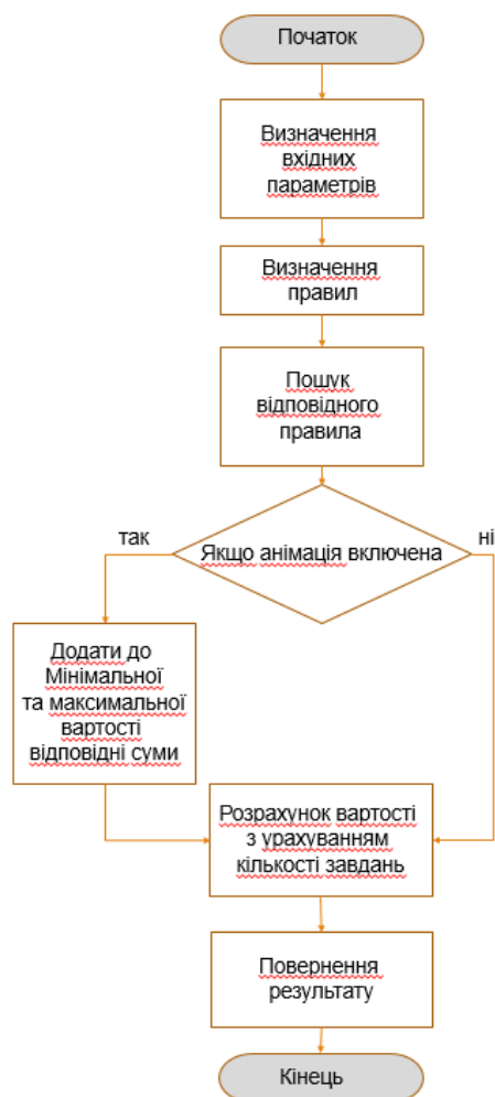
Рисунок 4.2 – Блок-схема алгоритма функції на JavaScript для обробки введених користувачем даних та визначення рекомендованої вартості проекту згідно з вказаними правилами
