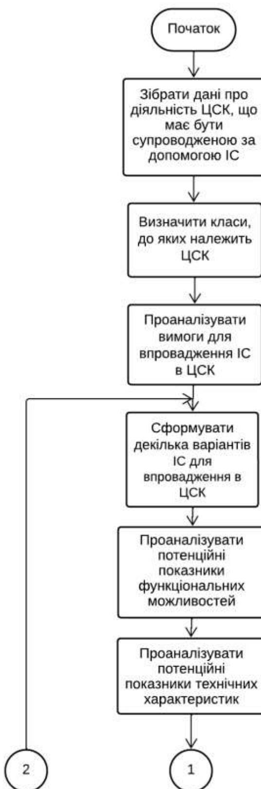
Рисунок 3.6 – Блок-схема алгоритму застосування запропонованого методу оцінювання ефективності функціонування ІС ЦСК (при впровадженні нової ІС)
