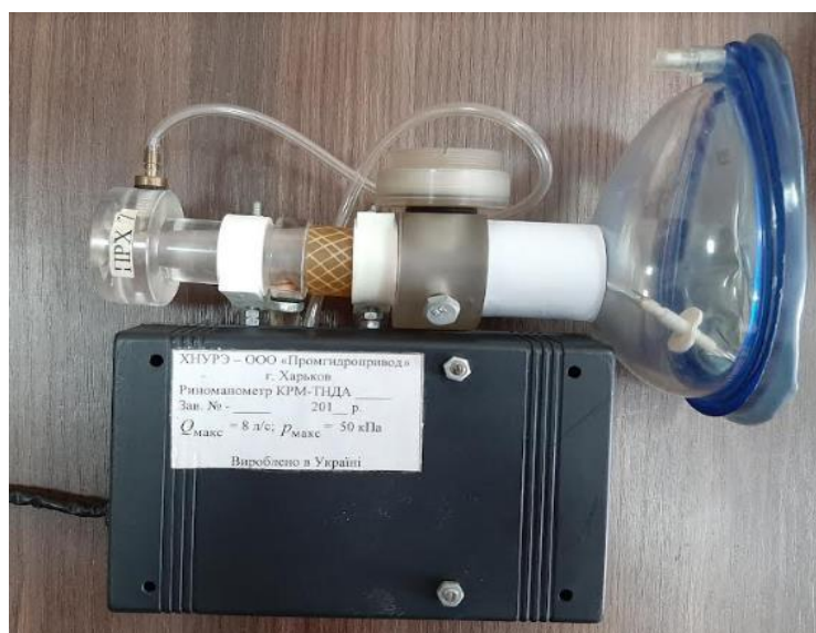
Рисунок 2 – Пристрій для тестування носового дихання на основі сертифікованого блоку виміру перепадно-витратних характеристик ТНДА-ПВХ
