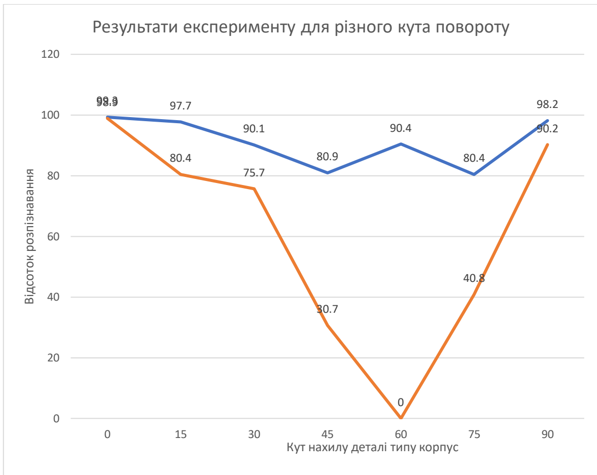
Рисунок 4.3 – Результати експерименту для різного кута повороту деталі
