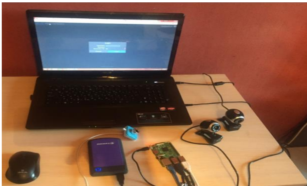
Рисунок 2.13 – Raspberry Pi з підключенням кабелю Ethernet до робочого столу або ноутбука
