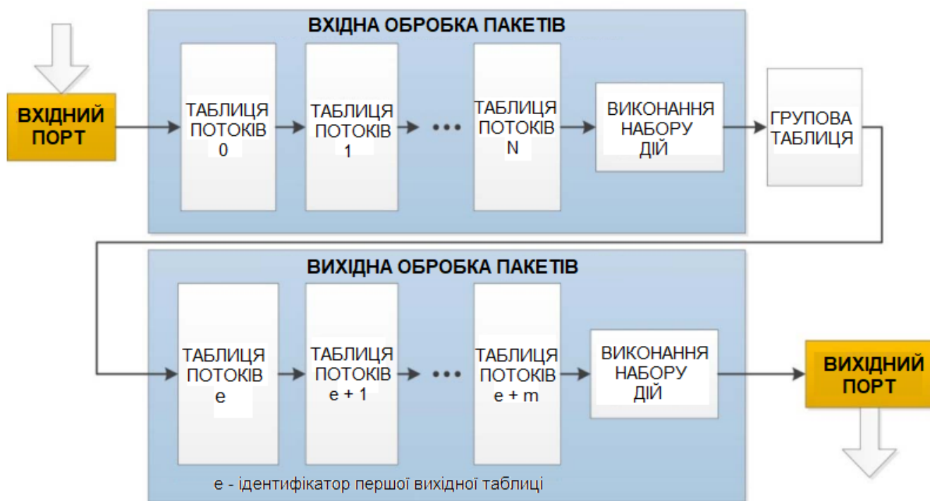
Рисунок 2.3 – Потік пакетів через конвеєр обробки
