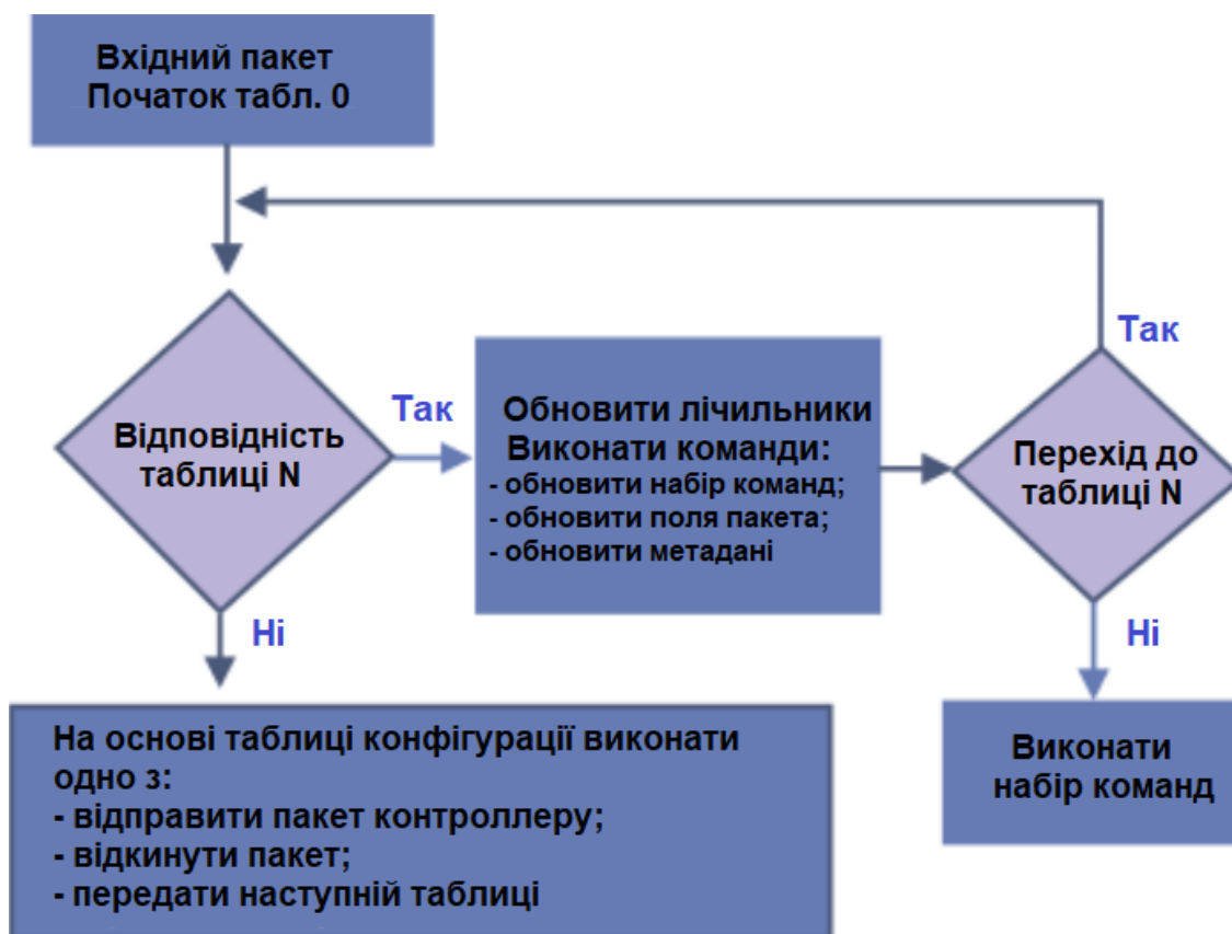
Рисунок 2.4 – Схема спрощеного алгоритму проходження пакета через OpenFlow-комутатор
