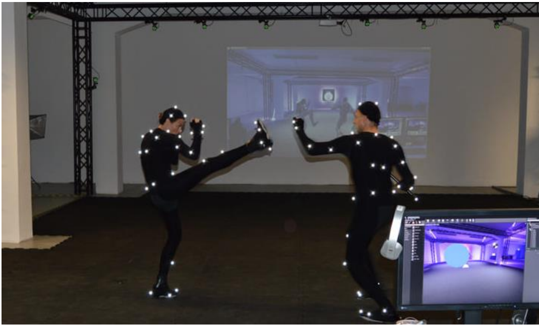
Рисунок 1.1 – Активні маркери оптичного методу захоплення руху [2]
