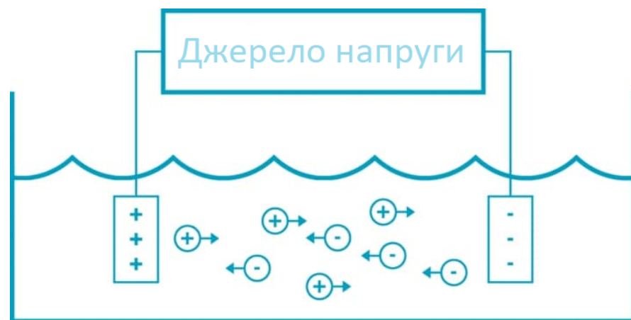
Рисунок 2.6 – Принцип роботи датчика TDS
