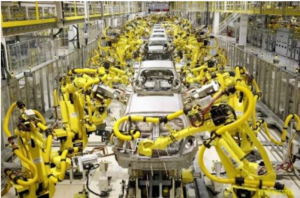
Рисунок 1 – Автоматизована лінія збору автомобілів за допомогою роботів
