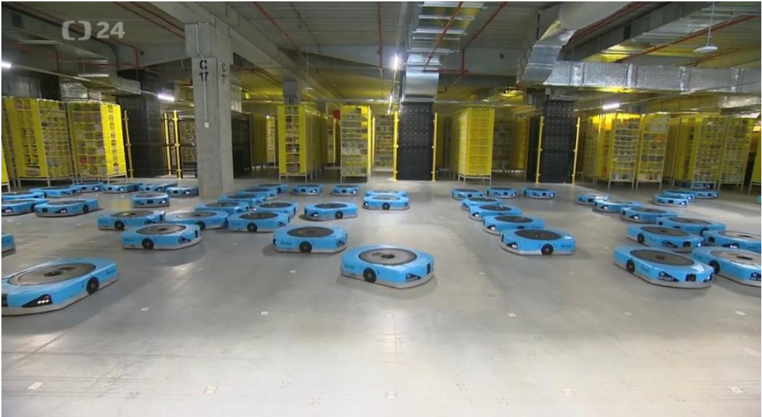
Рисунок 2 – Автоматизовані роботи для перевезення полиць з товаром
