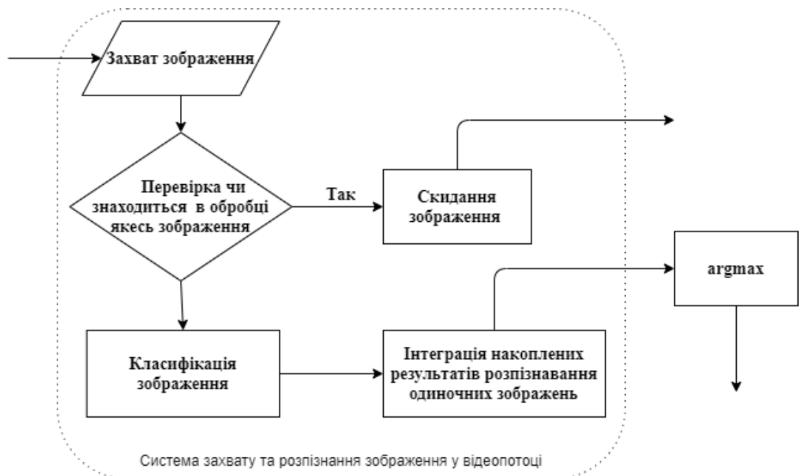
Рисунок 2.4 – Схема системи розпізнавання об'єкту у відеопотоці з тривіальною моделлю обслуговування
