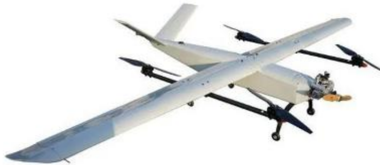
Рисунок 1.5 – Гібридний БПЛА з вертикальним зльотом та посадкою HW-V210A з нерухомим крилом
