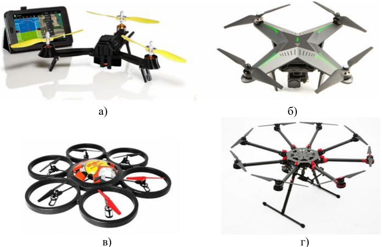
Рисунок 1.3 – Класифікація мультироторних БПЛА за кількістю роторів: трикоптери (а), квадрокоптери (б), гексакоптери (в) та октокоптери (г)
