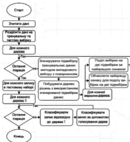
Рисунок - Блок-схема класифікатора випадкового лісу [Петрина, В. В., Дорошенко А. В., Сидоренко, Р. В., & Теслюк, В. М. (2023). Модель та засоби збирання та оброблення даних з використанням машинного навчання. Науковий вісник НЛТУ України, 33(3), 102-109. https://doi.org/10.36930/403303151 ]
