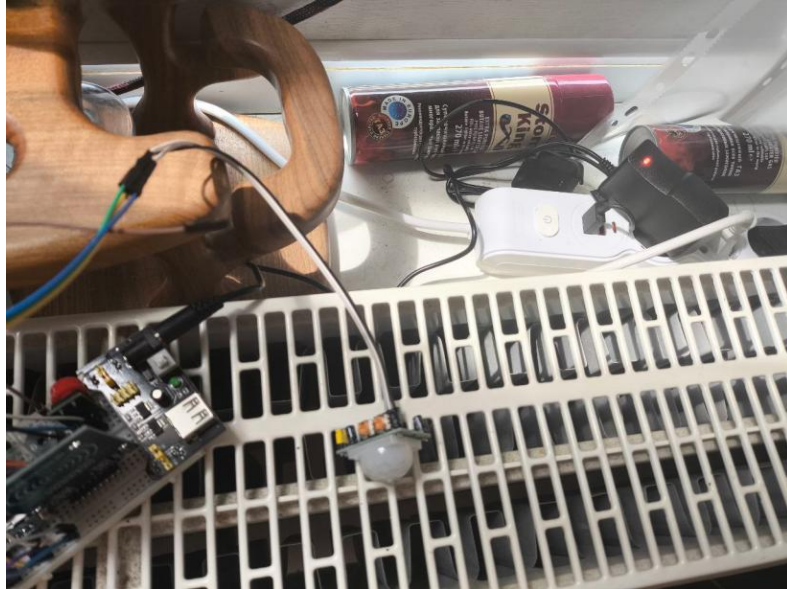
Рисунок 5.5 – Розташування HC-SR501 на макетній платі
