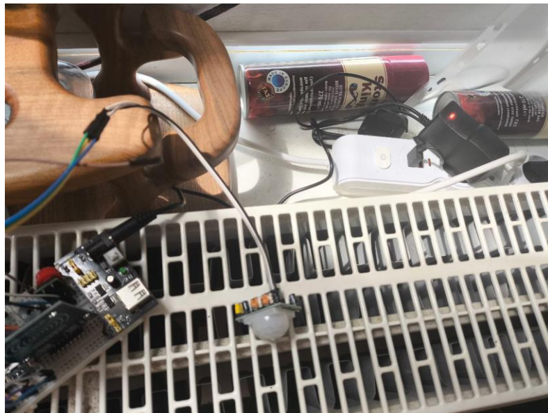
Рисунок 5.3 – Подача живлення на ESP32–CAM через макетну плату
