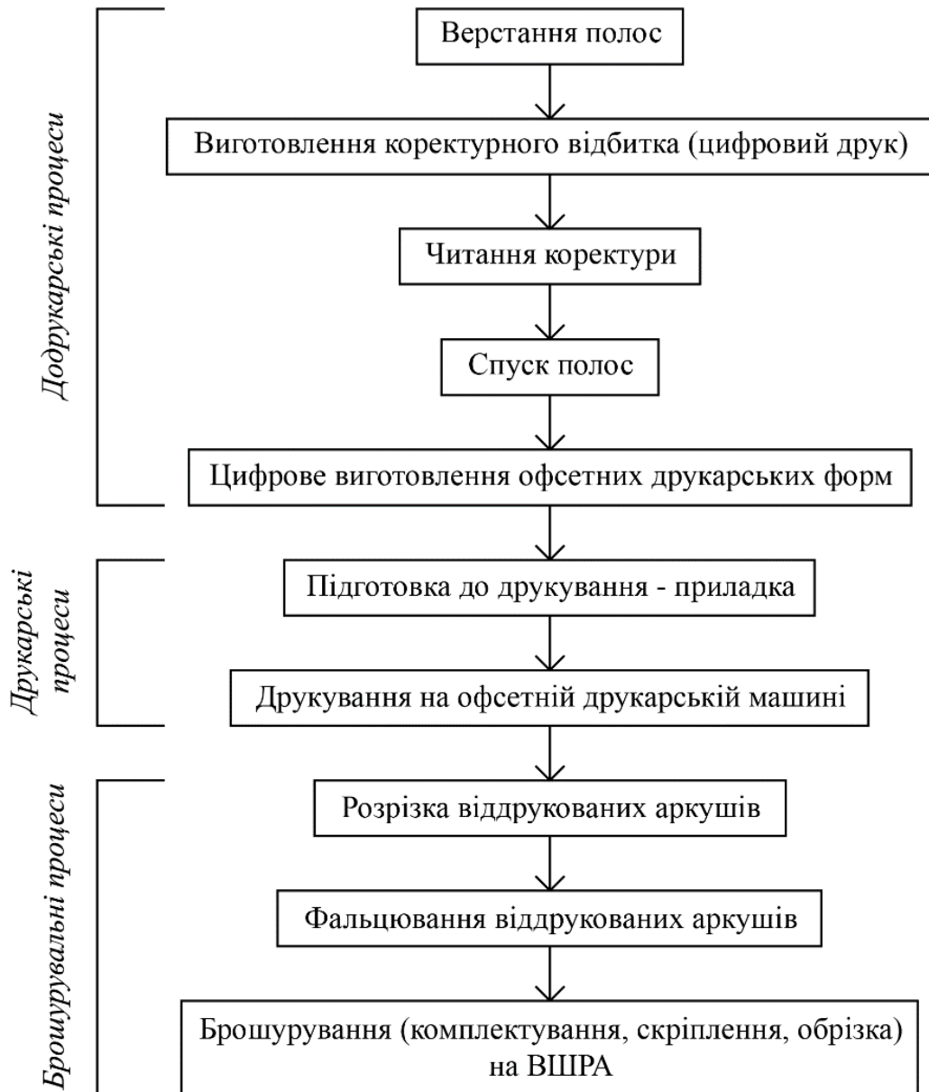
Рисунок 4.1 – Схема технологічного процесу виготовлення журналу
