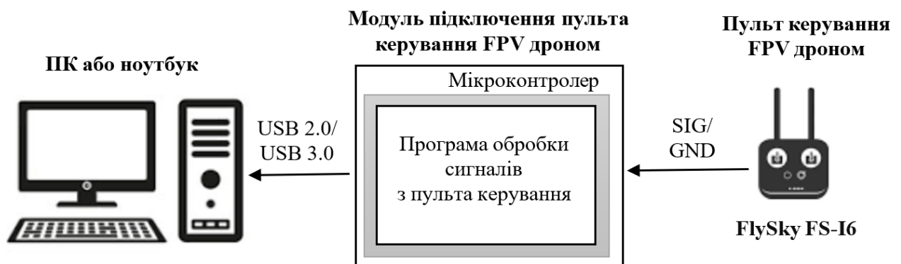
Рисунок 2.1 – Розроблена структурна схема модуля підключення пульта керування FPV дроном до ноутбука або ПК
