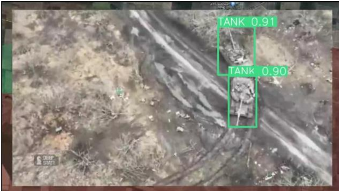
Рисунок 2.6 – Результат роботи YOLOv8nano (рисунок створено самостійно)
