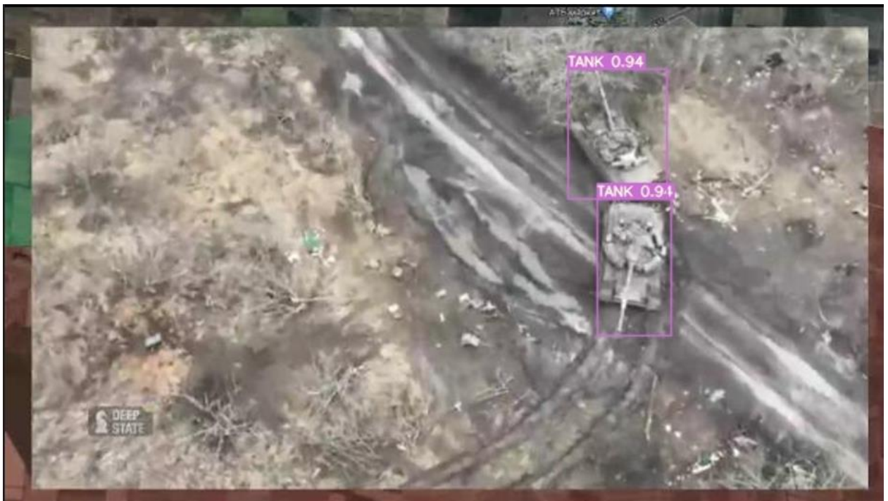
Рисунок 2.5 – Результат роботи YOLOv7-tiny (рисунок створено самостійно)
