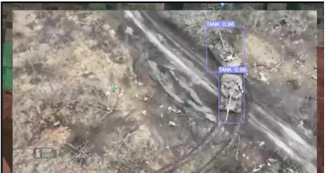
Рисунок 2.4 – Результат роботи YOLOv7 (рисунок створено самостійно)
