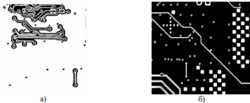
а) глобальна бінарizaція; б) адаптивна бінарizaція з автоматичним налаштування розміром скануючої ділянки
