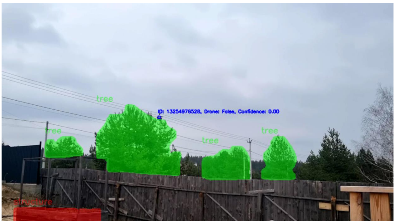
Рисунок 3.3 – Об'єкт втрачено із-за того що він залетів в зону дерев (виконано самостійно)
