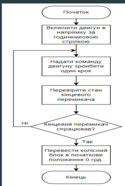
Рисунок А.15 – Алгоритм роботи модуля сортування в режимі калібрування
