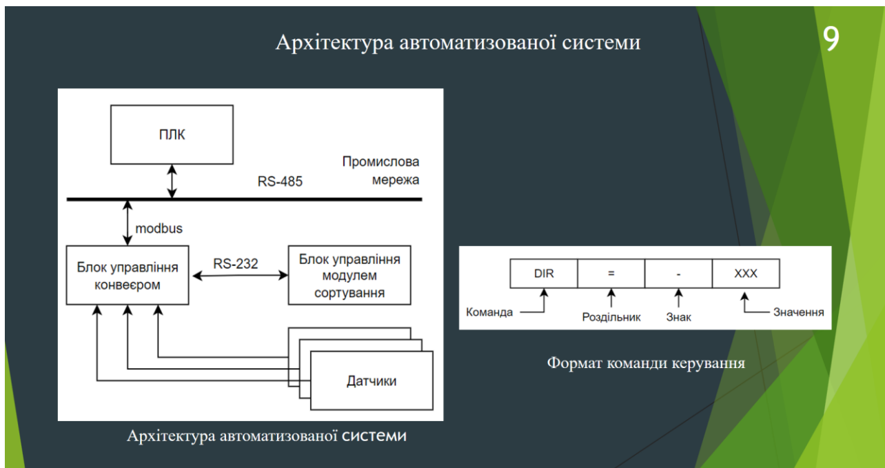
Рисунок А.9 – Архітектура автоматизованої системи
