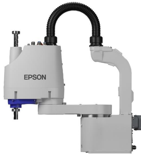
Рисунок 1.5 – SCARA-маніпулятор від компанії EPSON [17]
