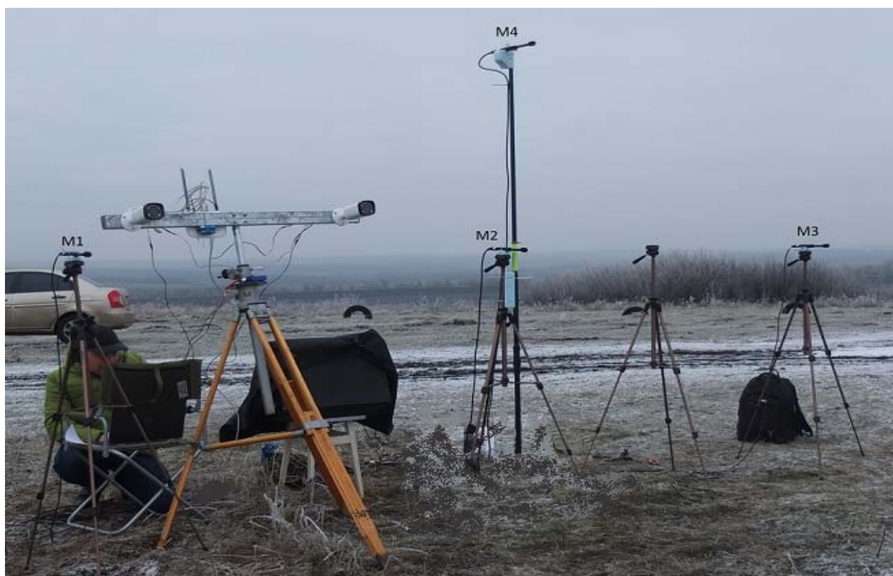
Рисунок 2.27 – Мікрофонна решітка М1-М4 пасивного содару
