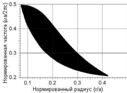
Рис. 7. Область геометрического существования ФЗЗ для длины волны 1.55 мкм для ФК с квадратной решеткой цилиндрических стержней (полученный результат)
