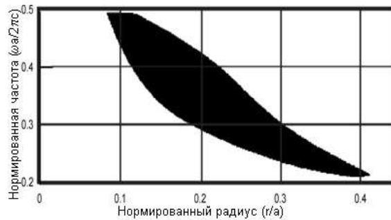
Рис. 8. Область геометрического существования ФЗЗ для длины волны 1.55 мкм для ФК с квадратной решеткой цилиндрических стержней (результат Янопулоса и соавторов)
