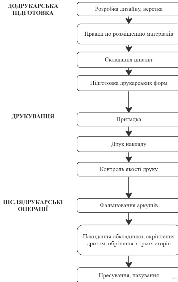
Рисунок 3.4 – Структурна схема технологічного процесу виготовлення інструкції
