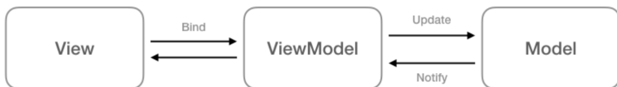
Рисунок 3.1 – Схема взаємодії MVVM
