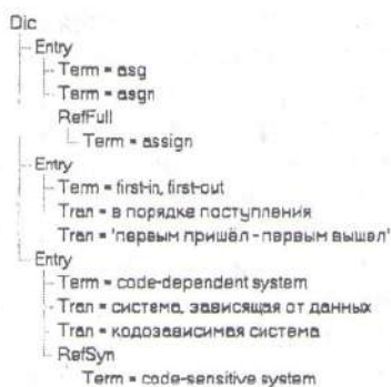
Рис. 5. Дерево содержательной структуры для фрагмента словаря и представляющий это дерево документ XML
