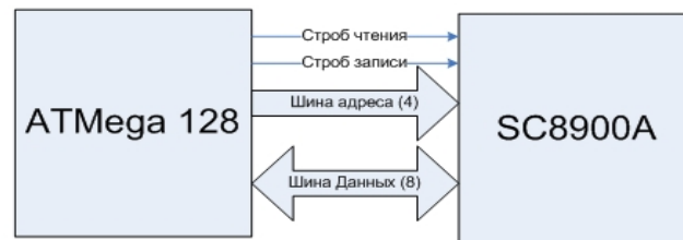
Рисунок 1– Структурная схема связки микроконтроллера AT Mega 128 и CS8900A.
