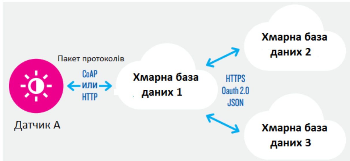
Рисунок 2.4 – Принципова схема моделі спільного використання даних на сервері
