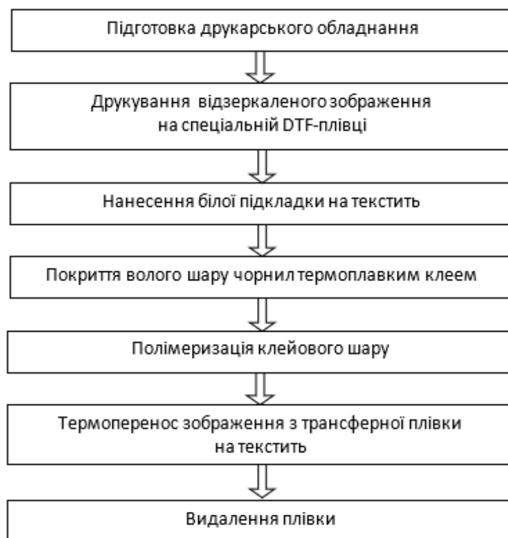
Рисунок 5.5 – Технологічна схема DTF-друку Джерело: Власна розробка
