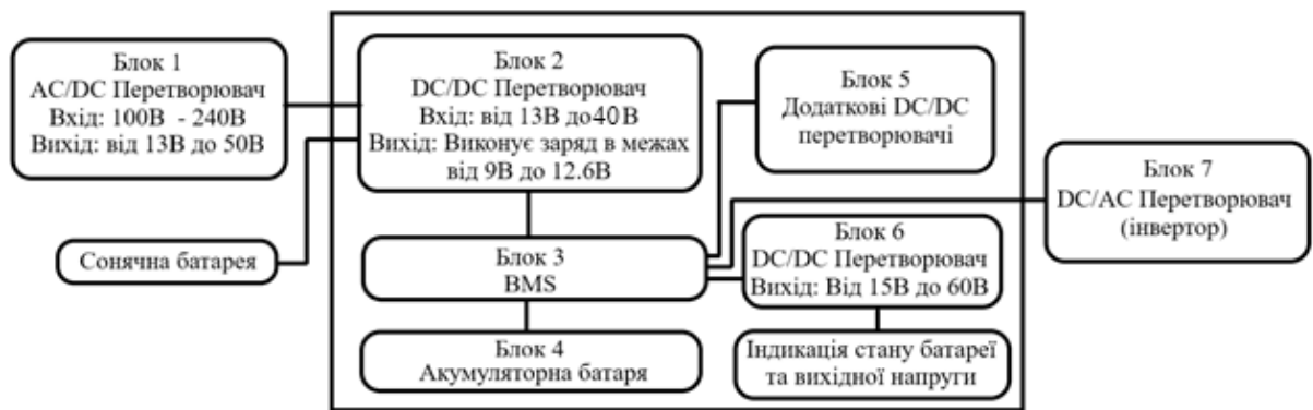
Рисунок 3.1 – Блок схема майбутньої портативної системи живлення
