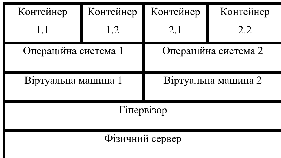
Рисунок 2.1 – Рівні віртуалізації обчислювального процесу
