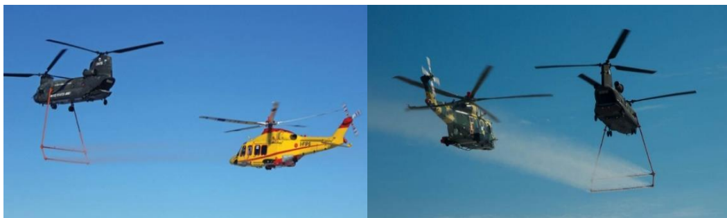
Рис. 1. Чінок армії США моделює хмару зледеніння для перевірки ефективності функціонування системи захисту від льоду гелікоптера AW139 Agusta [2]
