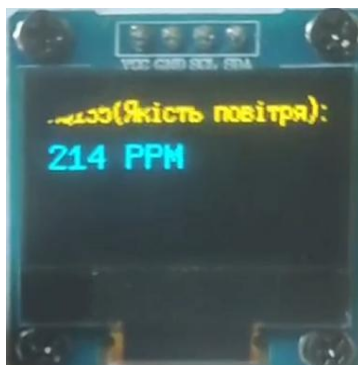
Рисунок 4.2 – Внутрішнє тестування MQ135
