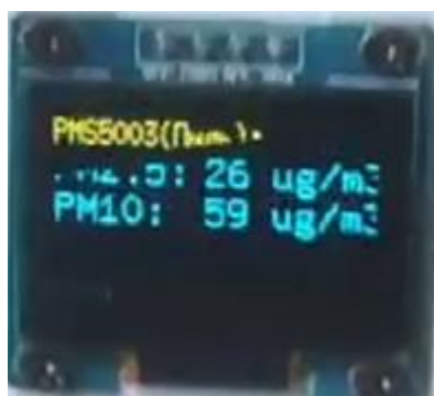
Рисунок 4.4 – Тестування роботи PMS5003
