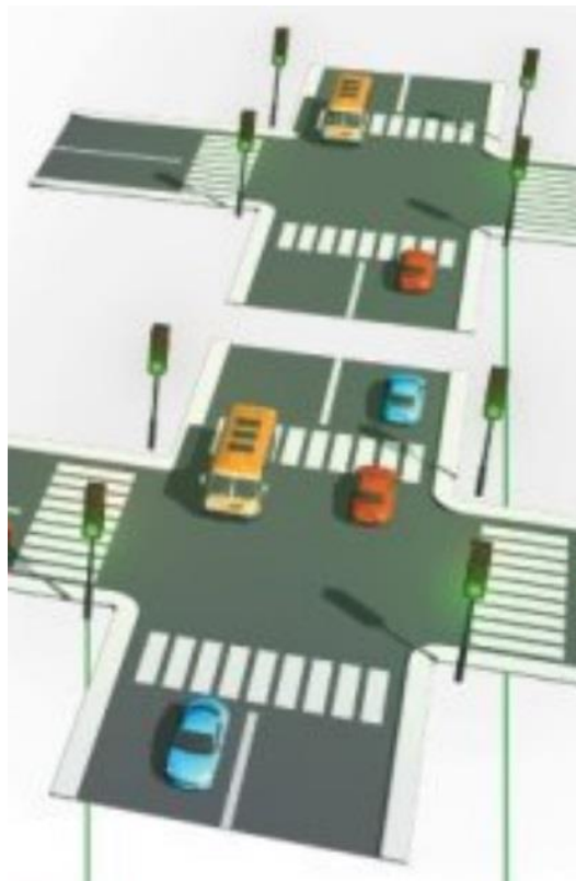
Рисунок 2.2 – Приклад роботи детекторів присутності (повної) транспортних засобів
