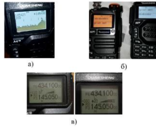
Рисунок 1 – Приклади реалізації налаштованих функцій на радіостанції QUANSHENG UV5 (K8): а) панорамний спектроаналізатор; б) месенджер повідомлень AFSK; в) RSSI bar
