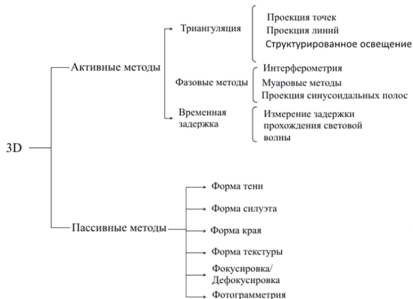
Рисунок 1 – Определения 3D-профиля на основе бесконтактных методов, использующих световое освещение
