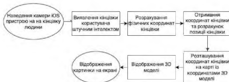
Рисунок 2 – Базовий алгоритм накладання 3D моделі на об'єкт
