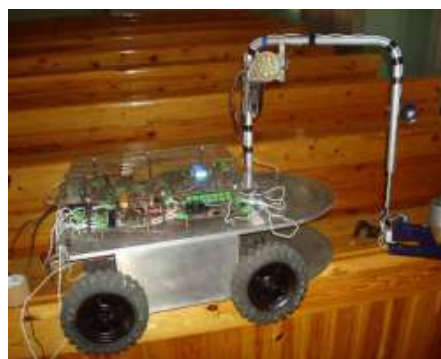
Рис.1. Зразок робота-маніпулятора для виявлення ВВП
