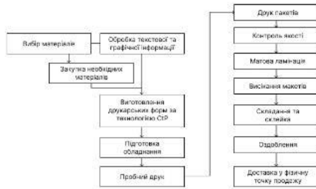
Рисунок 8.1 – Технологічна схема виготовлення пакетів
