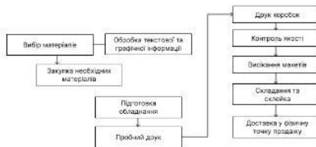
Рисунок 8.2 – Технологічна схема виготовлення поштових коробок
