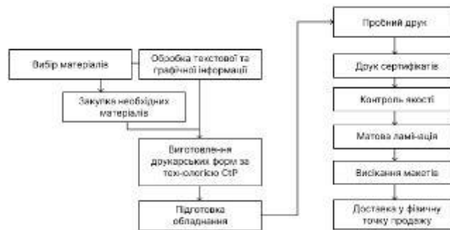
Рисунок 8.5 – Технологічна схема виготовлення сертифікатів
