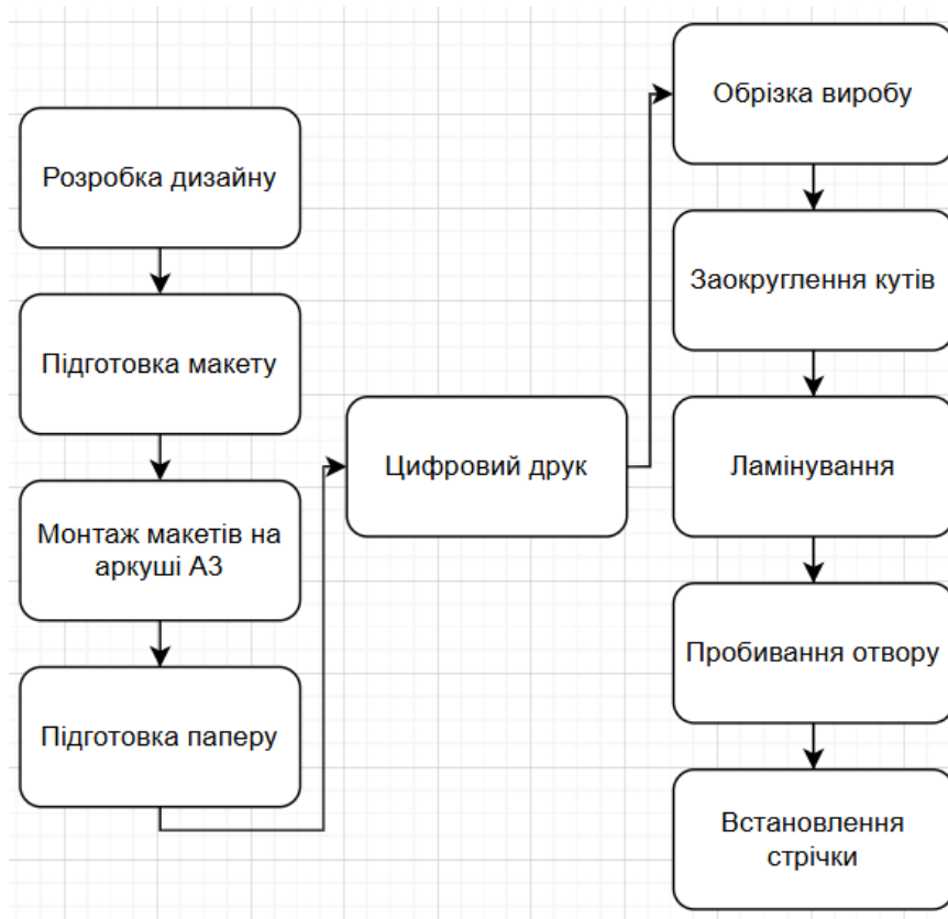
Рисунок 6.2 – Схема технологічного процесу виготовлення бейджів
