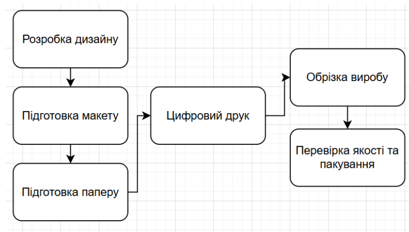
Рисунок 6.1 – Схема технологічного процесу виготовлення афіш
