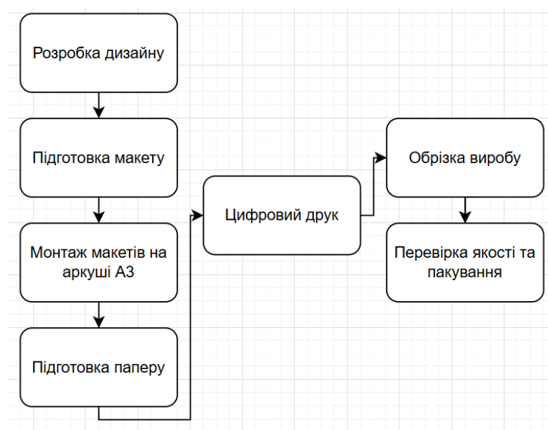
Рисунок 6.4 – Схема технологічного процесу виготовлення листівок
