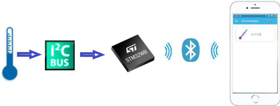
Рисунок 1 – Архітектура розробленої системи контролю температури
