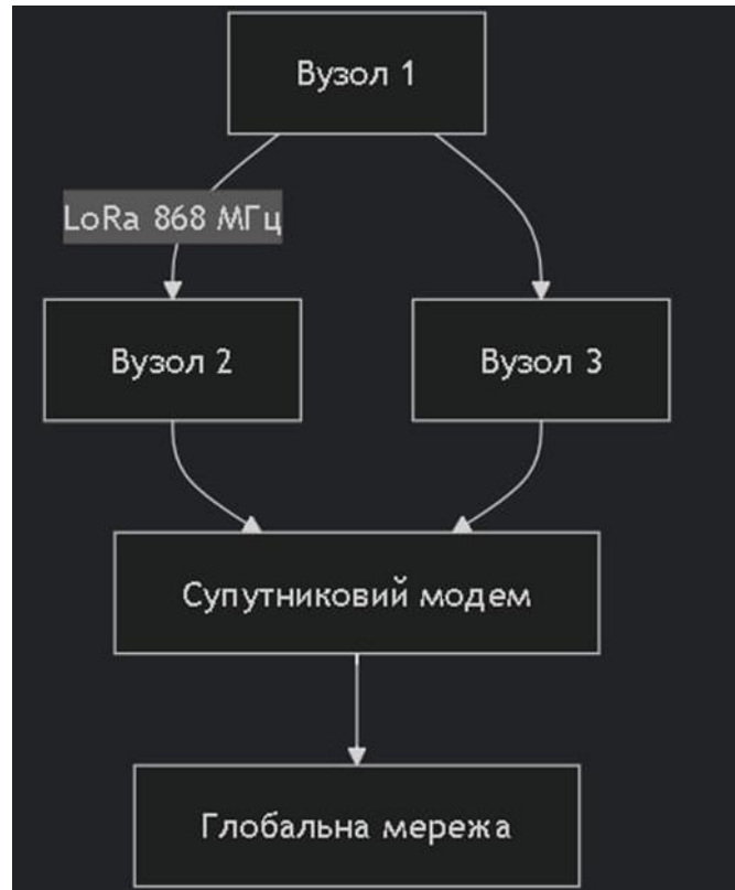
Рисунок 3.7 – Система катастрофостійкого зв'язку. Автономна mesh-мережа на LoRaWAN
